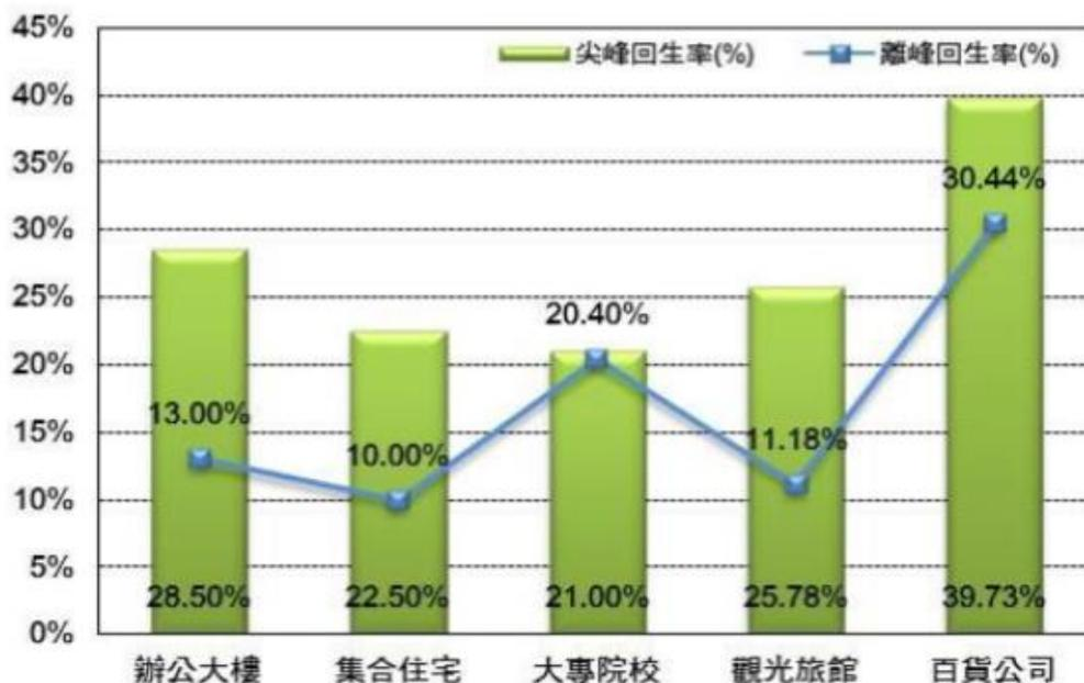
依據各建築類型取樣結果得知其尖離峰使用頻率與回饋電量之回生率成正比關係即電梯系統使用率越高者，其節能潛力越佳電梯樓層越高，機械位能差越大，越節能
